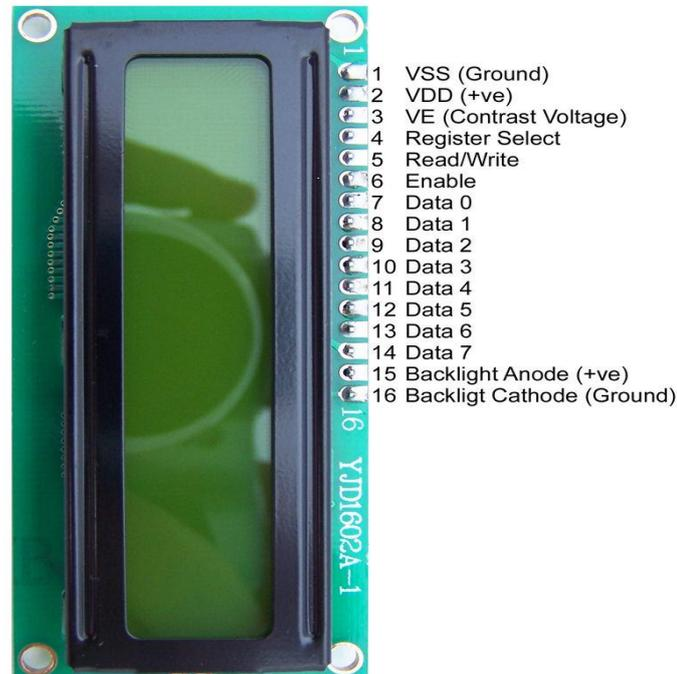
**Gambar 2.12 Konstruksi *Pin* LCD 16x2**
