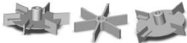
Gambar 4. Pengaduk Turbin pada Bagian Variasi
