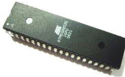
Gambar 2.15 Mikrokontroler ATmega 8535
