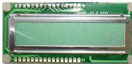
**Gambar 2.7.** Bentuk LCD 2x16
