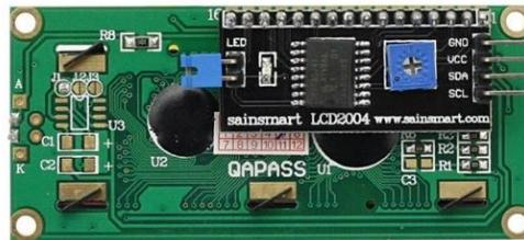
Gambar 2.19 Liquid Crystal Display 2x16 dengan Modul I<sup>2</sup>C.
