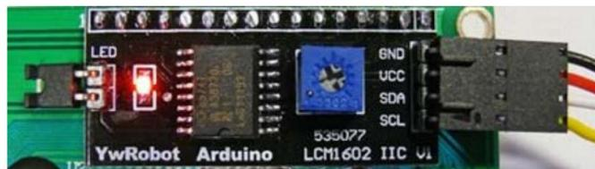
Gambar 2.22 Komunikasi 4 kabel I<sup>2</sup>C
