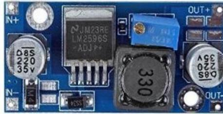
Gambar 2.17 Modul Konverter DC DC Penurun Tegangan
