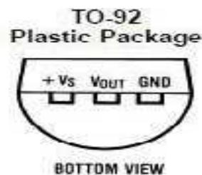
Gambar 2.1 Tampak Bawah Sensor Suhu LM35
