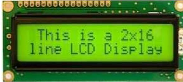
Gambar 2.11. LCD 16x2
