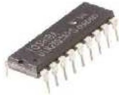
**Gambar 2.8** Bentuk Fisik IC ULN 2803
