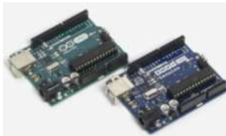
**Gambar 2.6 Mikrokontroler Arduino Atmega 328p**
