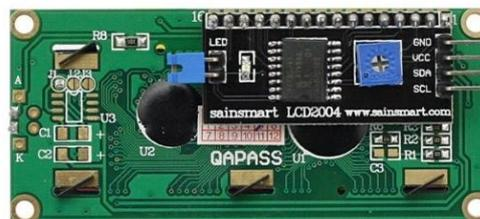
Gambar 2.20 Liquid Crystal Display 2x16 dengan Modul I<sup>2</sup>C.
