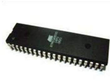
**Gambar 2.2** Mikrokontroler AVR ATmega 8535
