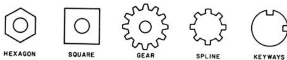
Gambar 32. Benda Kerja Yang Dikerjakan Dengan Fixture Index
