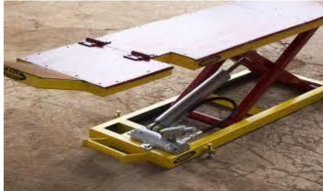
Gambar 2.5 Prinsip Kerja Alat Angkat Motor Sistem Hidrolik
