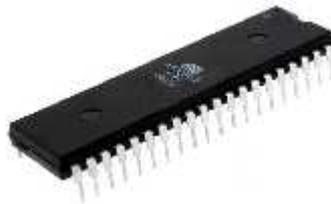
**Gambar 2.2** Mikrokontroler ATmega16
