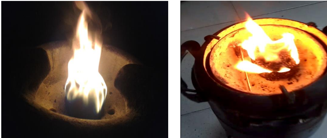
Gambar Penyalaan Briket Pada Kompor Briket
