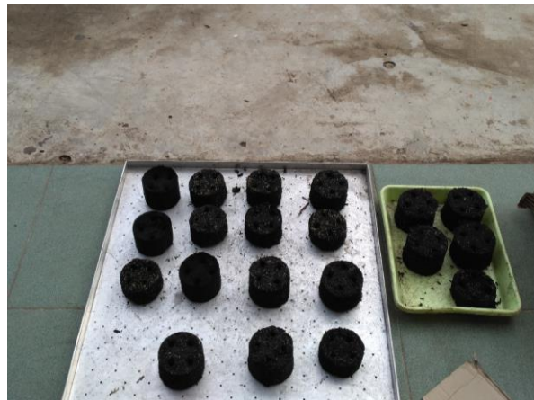
Gambar Pengeringan Briket Dibawah Sinar Matahari
