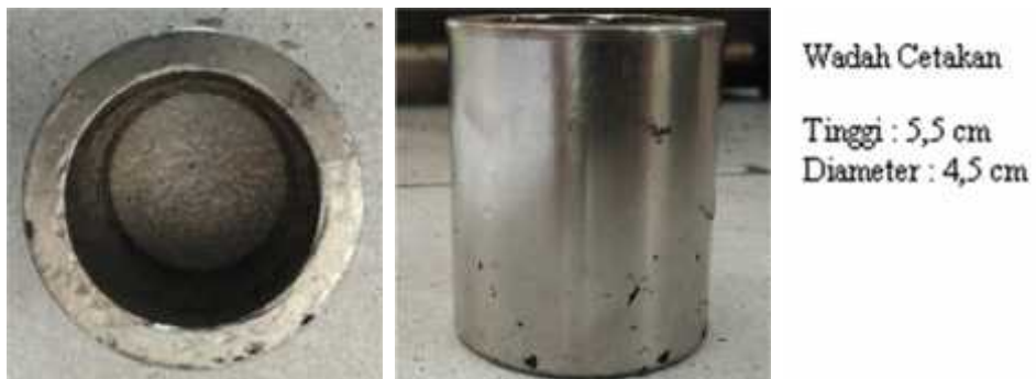
Gambar 18. Spesifikasi Wadah Cetakan
