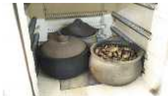
Cangkang biji karet di bakar dengan furnace
