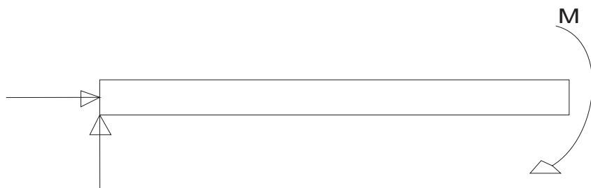
Gambar 2.10. Gaya yang berkerja pada poros atas penahan buah kelapa muda
