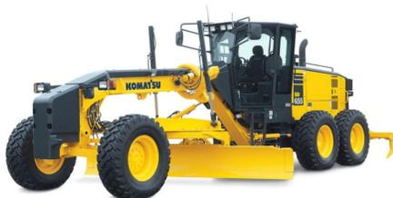
**Gambar. 2.3***Motor grader*
