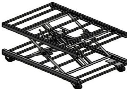
Gambar 2.19 Kerangka *Mechanic Creeper*
