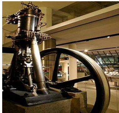
Gambar 2.1 Mesin Asli yang Dibuat Diesel tahun 1897, Dipajang di Museum di Munich, Jerman.
