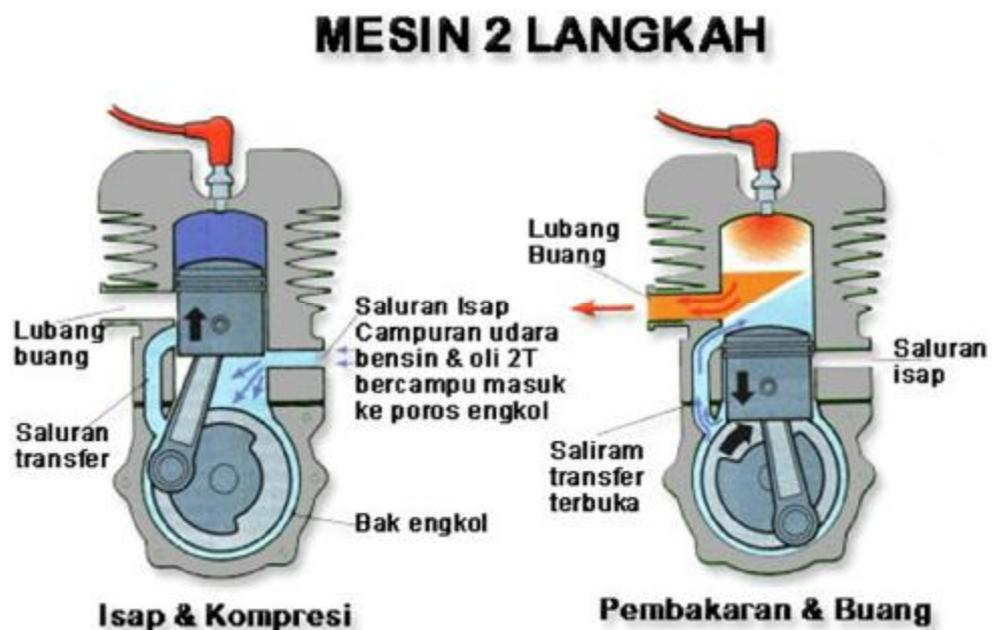
**Gambar 2.3** Siklus Kerja Motor bensin 2 langkah
