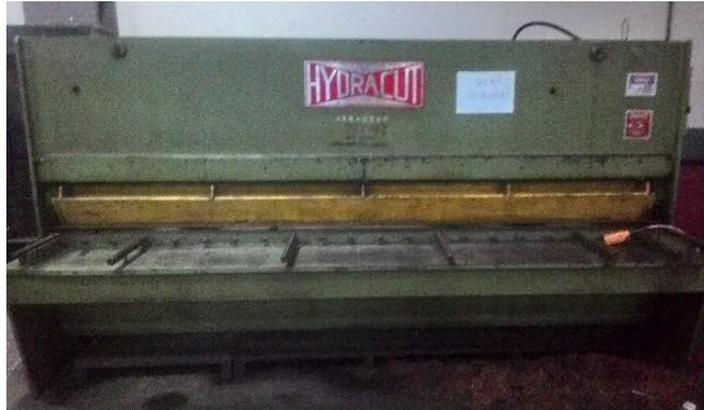
Gambar 2.21 Mesin Potong Guillotine Tenaga (*Power*)
