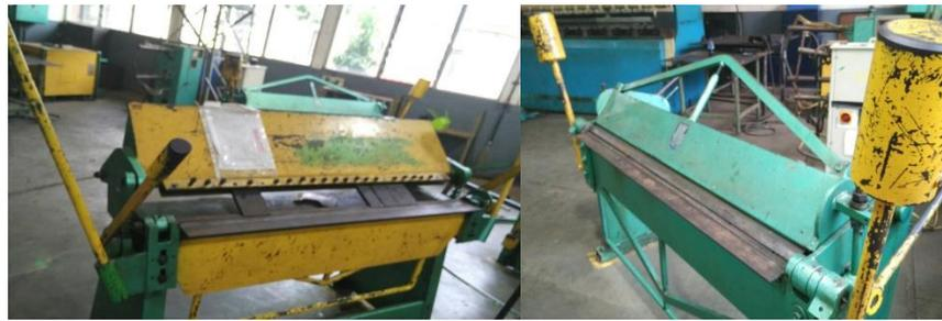
Gambar 2.23 Mesin *Bending*
