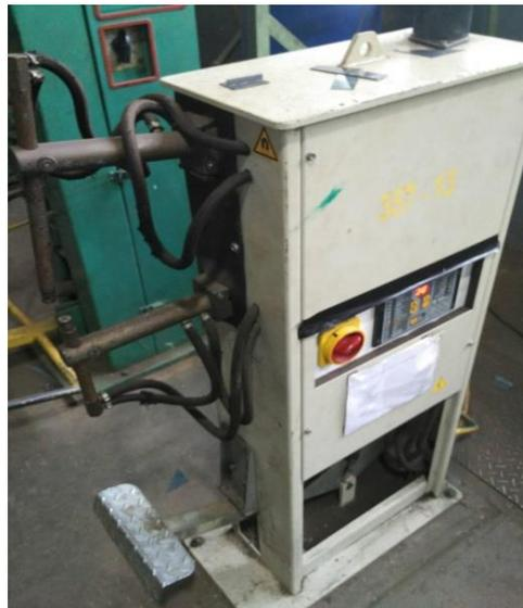
Gambar 2.25 Mesin Las Titik
