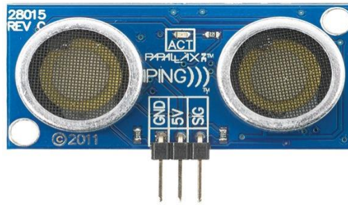
Gambar 2.3 Bentuk fisik sensor PING))) (Sumber: www.parallax.com )
