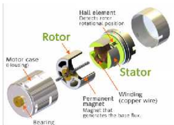
Gambar 2.17 Konstruksi Motor BLDC
