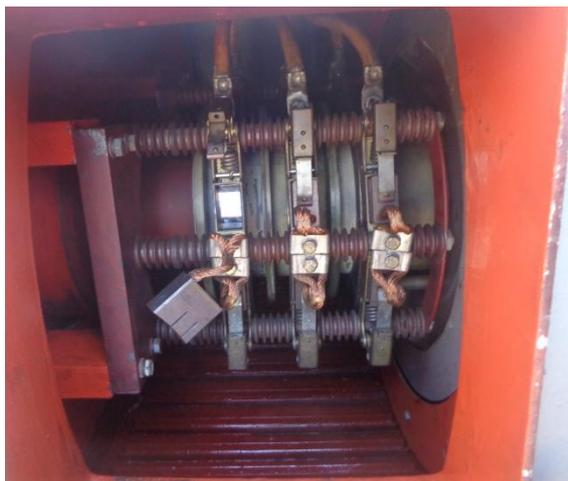
Gambar 2.3 *Slipring* dan *holder coal brush*
