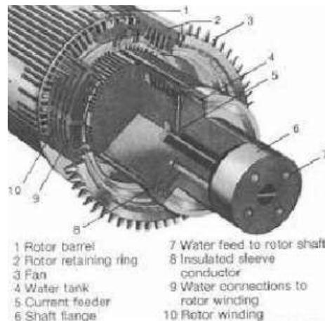
Gambar 2.8 Konstruksi rotor kutub silindris.<sup>10</sup>
