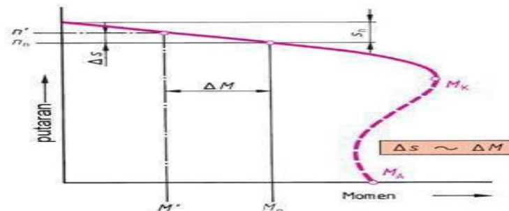
Gambar 2.9 Karakteristik putaran fungsi torsi
