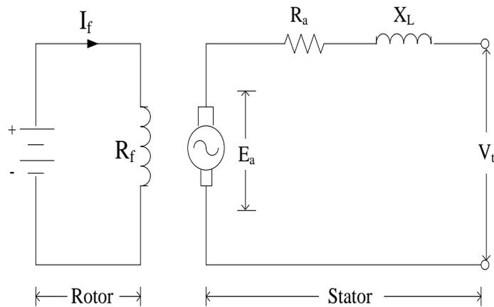
Gambar 2.5 Rangkaian Ekuivalen Generator Sinkron Tanpa Beban<sup>7</sup>
