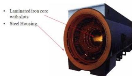
Gambar 2.3 Konstruksi Stator <sup>4</sup>
