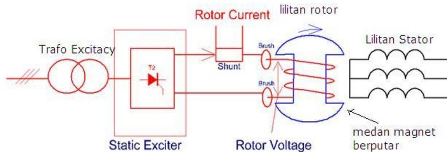
Gambar 2.13 Sistem Eksitasi dengan Sikat (*Brush Excitation*)<sup>16</sup>
