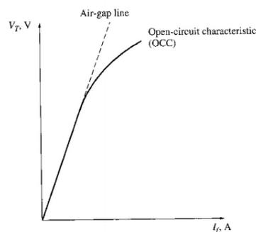
Gambar 2.10 Karakteristik *Open Circuit* pada Generator<sup>12</sup>
