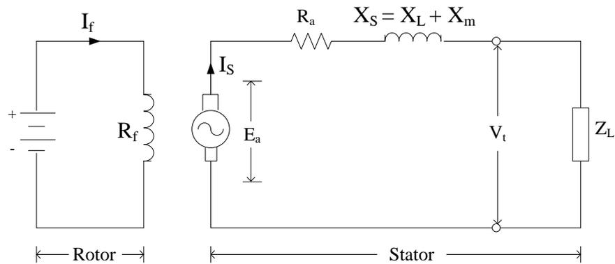
Gambar 2.7 Rangkaian Ekuivalen Generator Sinkron Berbeban<sup>9</sup>
