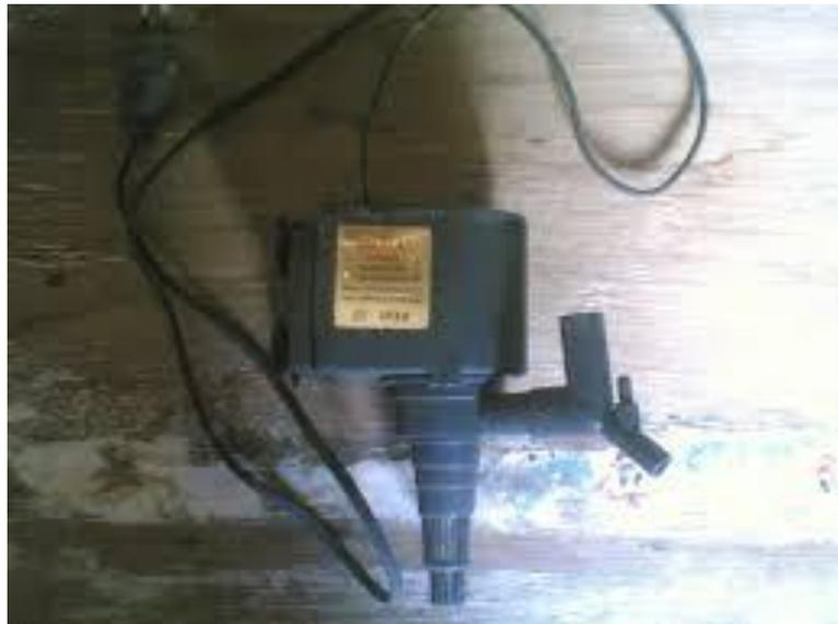
**Gambar 2.7 Mesin pompa air aquarium**
