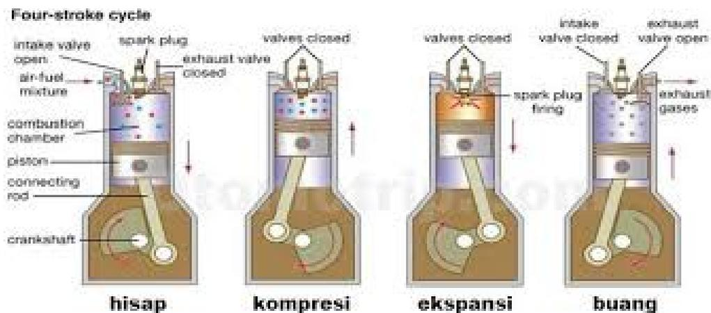
Gambar 2.8 Siklus Kerja Motor Diesel 4 Langkah
