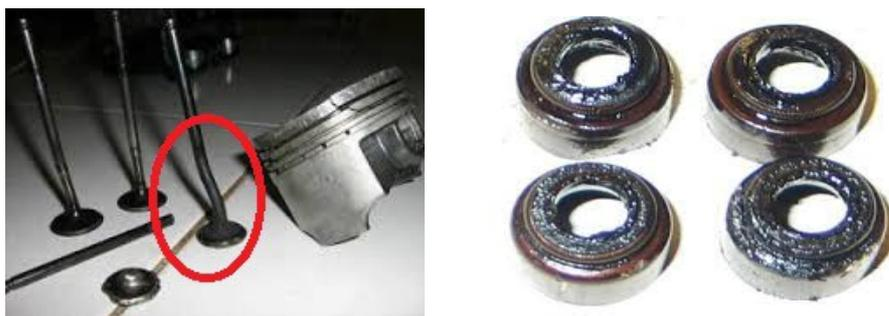
*Gambar 2.28 Komponen-komponen katup yang rusak*
