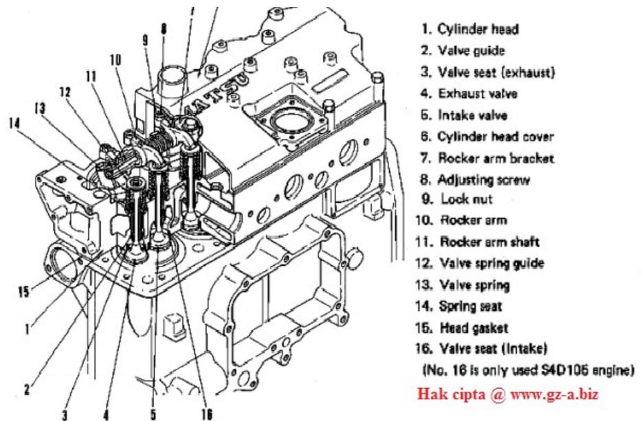
Gambar 2.2 Kontruksi Cylinder Head
