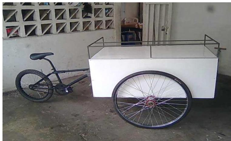
Gambar 2.3 Sepeda Roda Tiga dengan Gerobak Didepan
