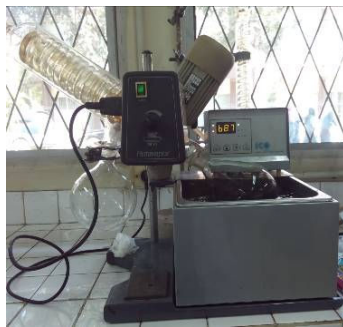
Evaporasi dengan rotary evaporator hingga larutan pekat pada suhu 70°C
