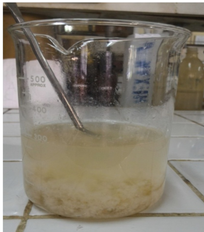
Gambar 23. Proses Penambahan Asam Asetat (Netralisasi)
