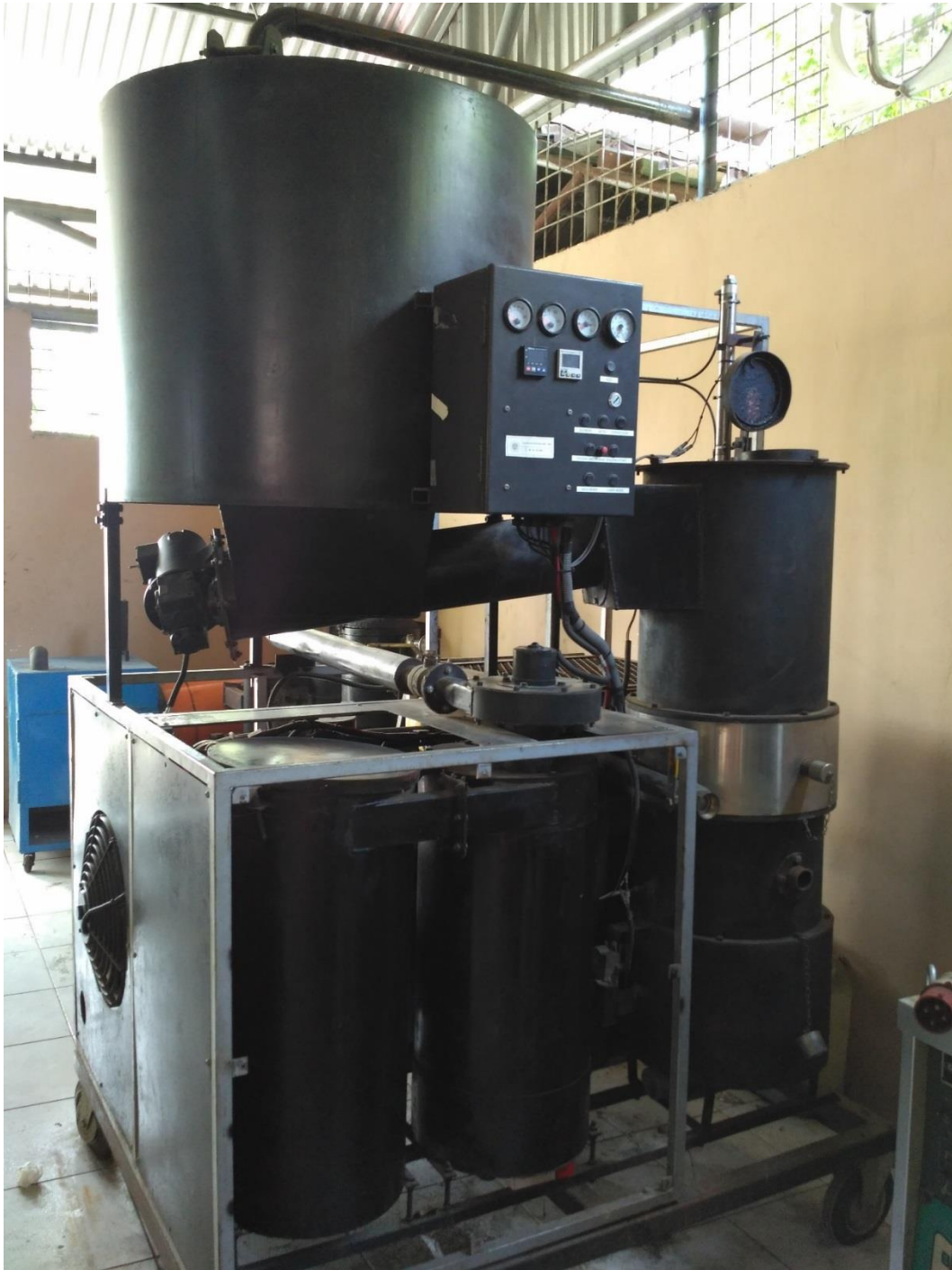
Downdraft Gasifier Secara Keseluruhan
