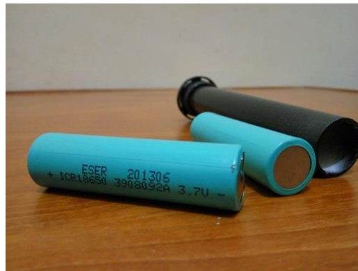
Gambar 2.1 Baterai Li Ion 18650
