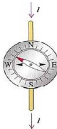
**Gambar 2.7 (c)** Percobaan Oestred Untuk Membuktikan GGL dapat Menimbulkan GGM
