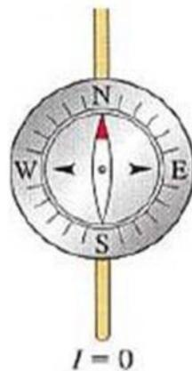
**Gambar 2.7 (a)** Percobaan Oersted Untuk Membuktikan GGL dapat Menimbulkan GGM
