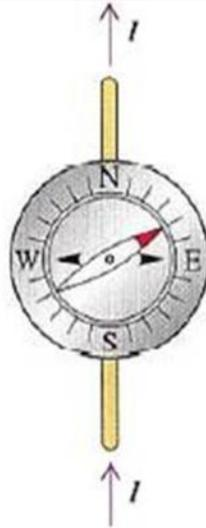
**Gambar 2.7 (b)** Percobaan Oestred Untuk Membuktikan GGL dapat Menimbulkan GGM
