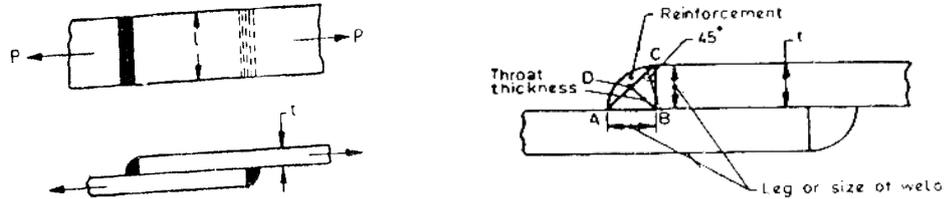
Gambar 2.10: Sambungan las *tipe lap joint*
