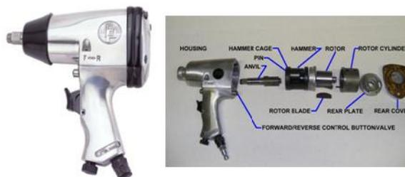
Gambar 2.2: Air impact dan komponen-komponennya
