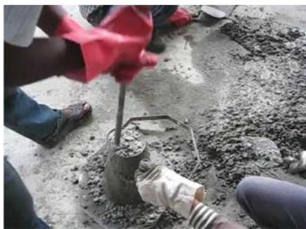
Gambar 2.7 Pengujian slump
