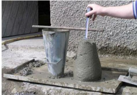
Gambar 2.8 Pengukuran tinggi slump
