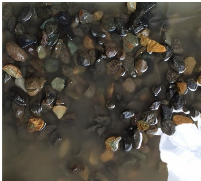
Gambar Pengujian Berat Jenis Dan Penyerapan Batu Split
