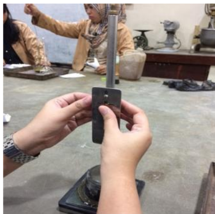
Gambar Pengujian Waktu Ikat Semen
