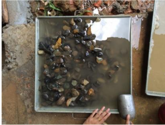
Gambar Pencucian Batu Split Ukuran 2/3
