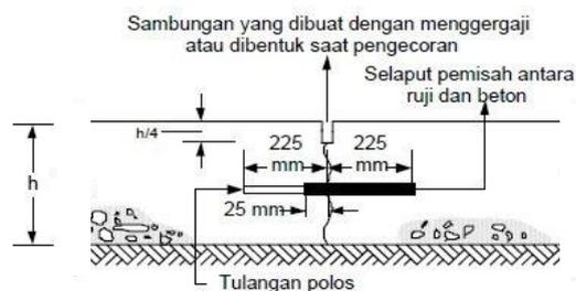
**Gambar 2.34 Sambungan Susut Melintang dengan Ruji**
