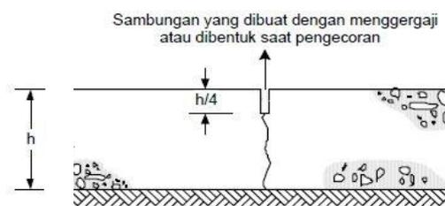
**Gambar 2.33 Sambungan Susut Melintang Tanpa Ruji**
