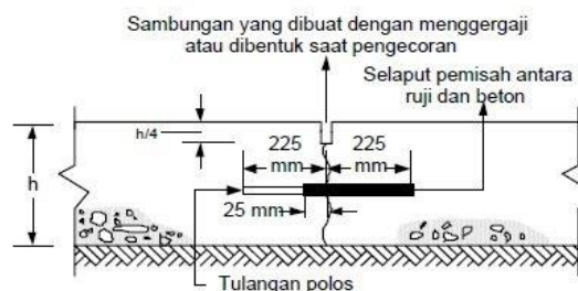
Gambar 2.19 Sambungan Susut Melintang dengan Ruji
