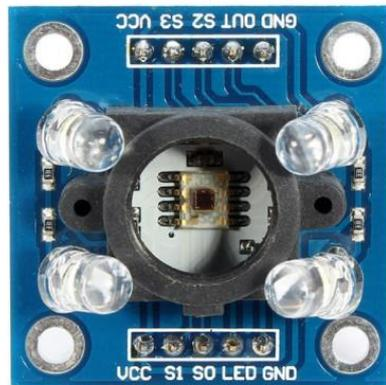
**Gambar 2.5. Modul Sensor Warna**
