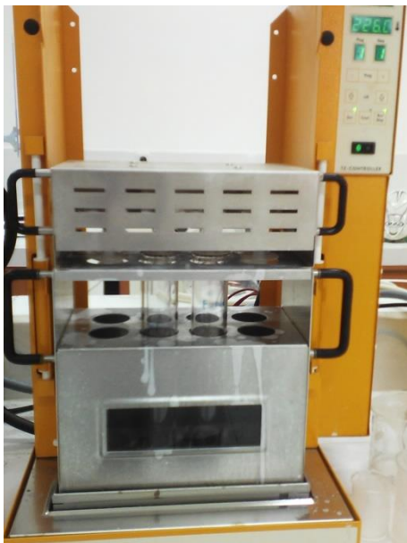
Gambar 13. Proses Destruksi Sampel
