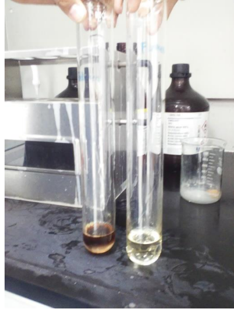
Gambar 12. Sampel Setelah ditambahkan 15 mL H_2SO_4
