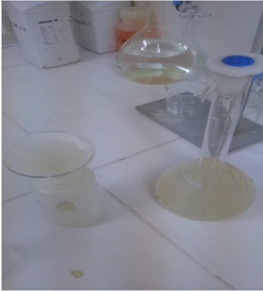
Gambar 29. Sampel Disaring dengan Kertas Saring Untuk Didapatkan Filtratnya Sebanyak 25 mL kedalam Labu Ukur 50mL
