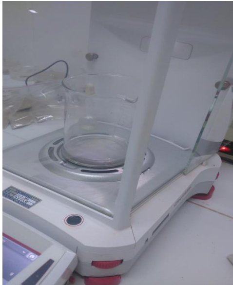
Gambar 25. Sampel Ditimbang Sebanyak 5gr Kedalam Gelas Kimia
