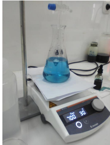
Gambar 16. Distilat dititrasi dengan NaOH 0,5 N
