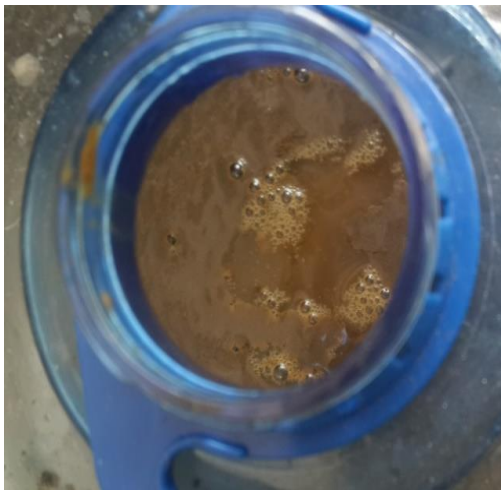
Gambar 10. Pupuk Organik Cair digester Sedimentasi Setelah di Fermentasi Anaerob selama 10 hari
