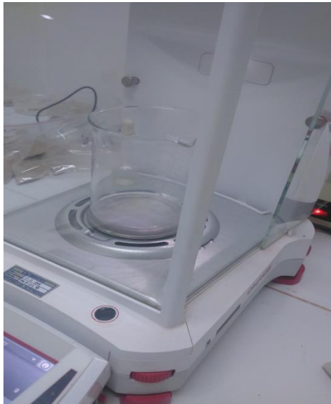
Gambar 18. Sampel Ditimbang Sebanyak 5gr Kedalam Gelas Kimia
