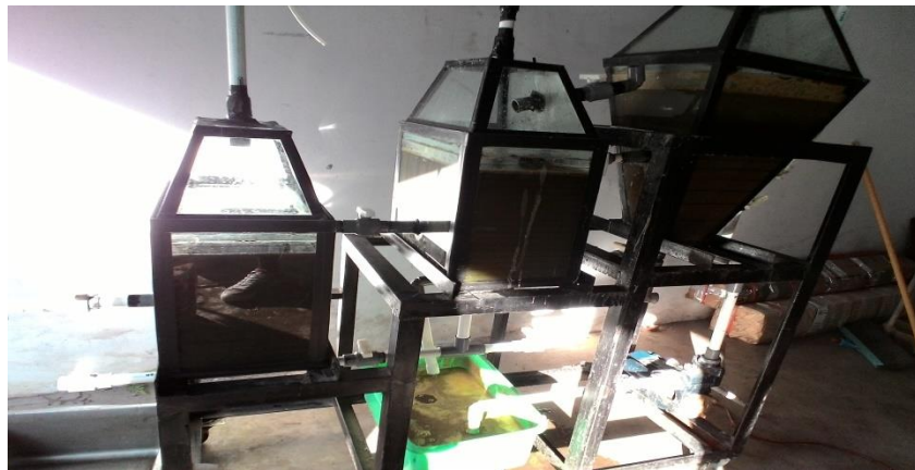
Gambar 1. Digester Sedimentasi dan Fermentasi Biogas
