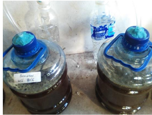
Gambar 9. Proses Fermentasi Anaerob Selama 10 Hari
