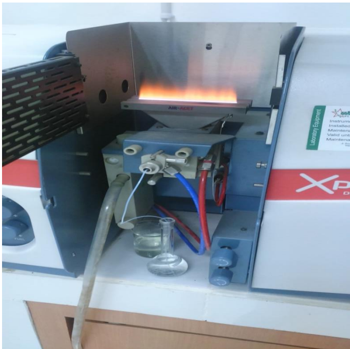
Gambar 31. Sampel yang telah Ditambahkan Pereaksi dan Diencerkan dengan Aquadest dianalisa Menggunakan Spektrofotometer Atomic Absorbtion Spectroscopi (AAS)
