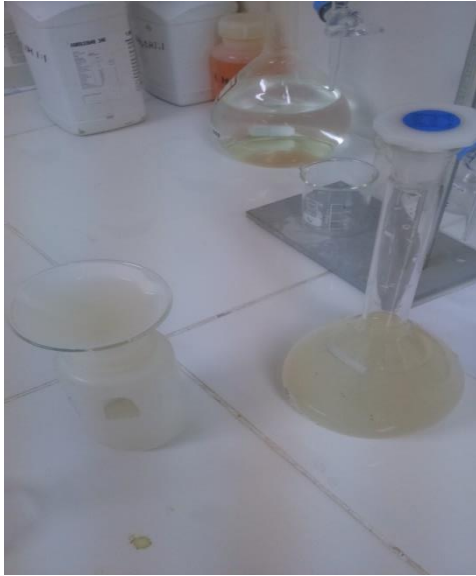
Gambar 22. Sampel Disaring dengan Kertas Saring Untuk Didapatkan Filtratnya Sebanyak 5 mL kedalam Labu Ukur 100mL
