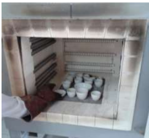
Gambar 33. Proses Penentuan Kadar Zat Terbang
