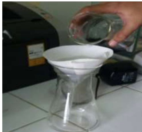
Gambar 36. Proses Penyaringan Larutan Fe
