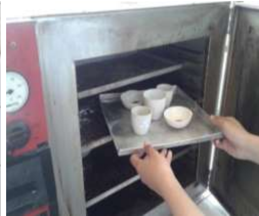
Gambar 31. Proses Penentuan Kadar Air
