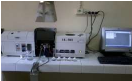
Gambar 37. Sampel dianalisa dengan Spektrofotometer Serapan Atom
