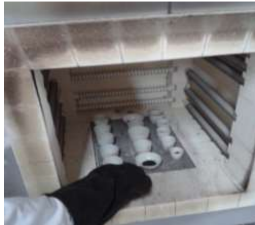
Gambar 32. Proses Penentuan Kadar Abu
