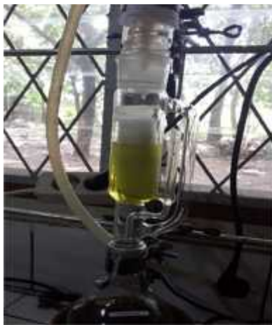
Gambar 3. Ekstraksi Mikroalga dengan metode Soxhlet
