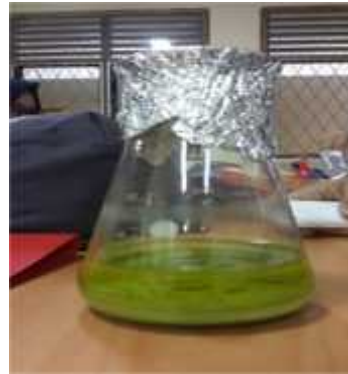
Gambar 2. Ekstraksi Mikroalga dengan metode Maserasi
