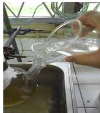
Gambar 12. Pencampuran Larutan KOH dan metanol kedalam reaksi Transesterifikasi
