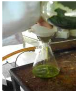
Gambar 4. Proses Penyaringan dengan alat penyaringan vakum (Untuk Ekstraksi Maserasi)
