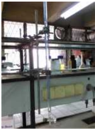
Gambar 9. Titrasi Penentuan %FFA FAME
