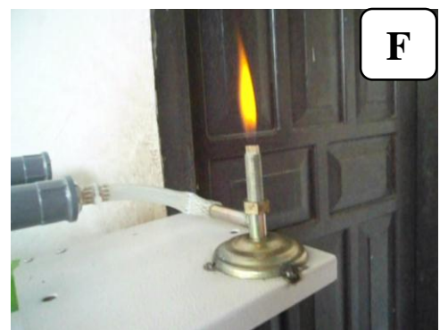
Gambar 19. A) Pencampuran Larutan NaOH dengan Bahan Baku Air 6 Liter, B) Memasukkan Bahan Baku ke dalam Alat Prototype Water Electrolyzer , C) Pengisian Tabung Penampung Gas Hidrogen dan Oksigen, D) Penampungan Produk Gas Hidrogen ke dalam Sampel Bag, E) Produk Gas Hidrogen, F) Nyala Api yang Dihasilkan pada Gas Hidrogen.
