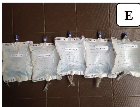
Gambar 19. A) Pencampuran Larutan NaOH dengan Bahan Baku Air 6 Liter, B) Memasukkan Bahan Baku ke dalam Alat Prototype Water Electrolyzer , C) Pengisian Tabung Penampung Gas Hidrogen dan Oksigen, D) Penampungan Produk Gas Hidrogen ke dalam Sampel Bag, E) Produk Gas Hidrogen, F) Nyala Api yang Dihasilkan pada Gas Hidrogen.
