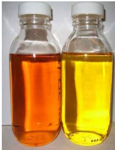
Gambar 2.14. Minyak Isolasi Transformator
