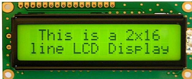
**Gambar 2.7** Bentuk Fisik LCD 16x2
