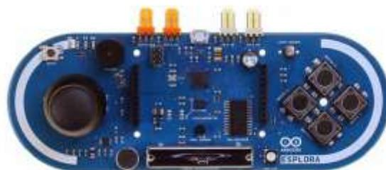
**Gambar 2.13 Bentuk Fisik Arduino *Esplora***
