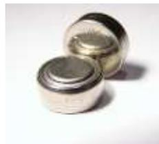
**Gambar 2.38 Bentuk Fisik Baterai *Zinc Air Cells***
