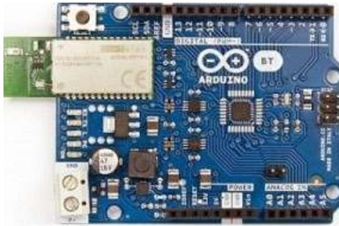
**Gambar 2.14 Bentuk Fisik Arduino BT**
