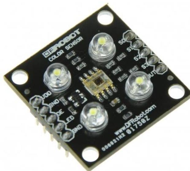
**Gambar 2.4 Sensor Warna TCS 3200**
